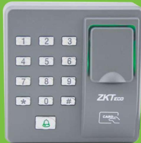
El X7 es un lector biométrico compacto para control de acceso que incorpora un rápido y preciso algoritmo de identificación de huellas digitales.
